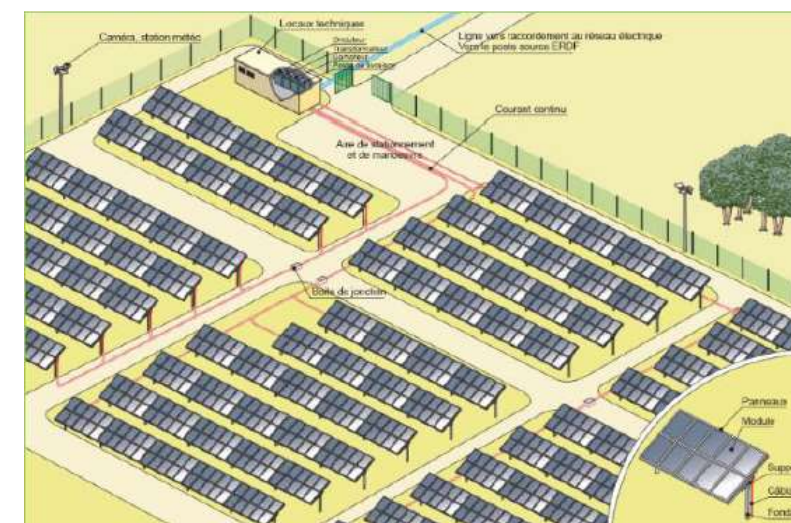
Figure 8 - Principe d'implantation d'une centrale solaire (source : Guide méthodologique de l'étude d'impact d'une centrale photovoltaïque au sol, 2011)
