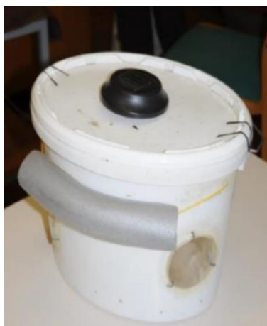
Photos 8 : Dispositif de capture passive de type Amphicapt (modèle Ortmann) présenté hors installation (à gauche) et exemple de déploiement opérationnel en milieu aquatique (à droite) © GEONAT-IDF
