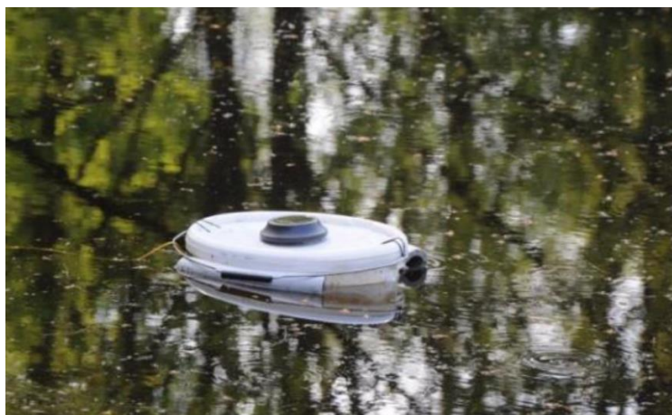
Photos 8 : Dispositif de capture passive de type Amphicapt (modèle Ortmann) présenté hors installation (à gauche) et exemple de déploiement opérationnel en milieu aquatique (à droite) © GEONAT-IDF
