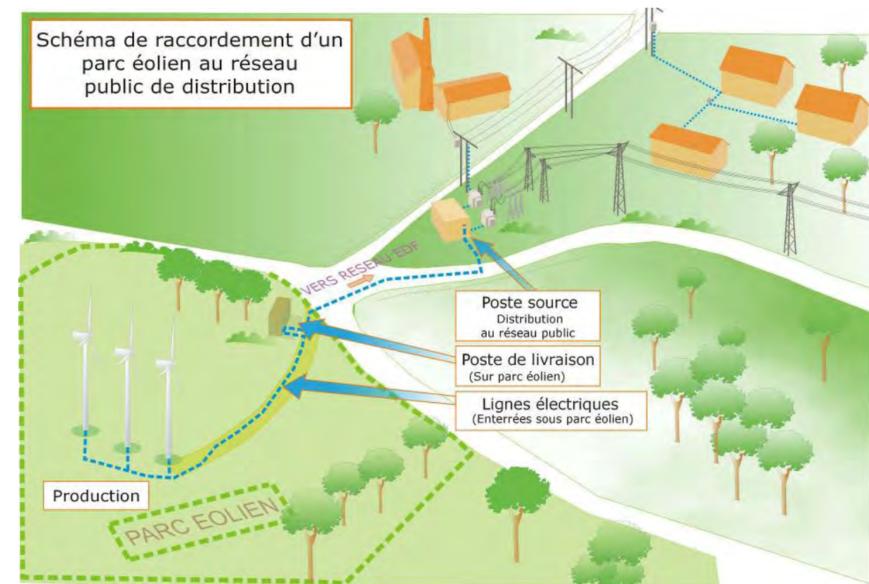
Figure 8 : Composants du parc éolien
