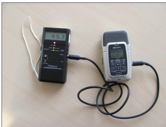
PETTERSSON D240X couplé à un enregistreur numérique
