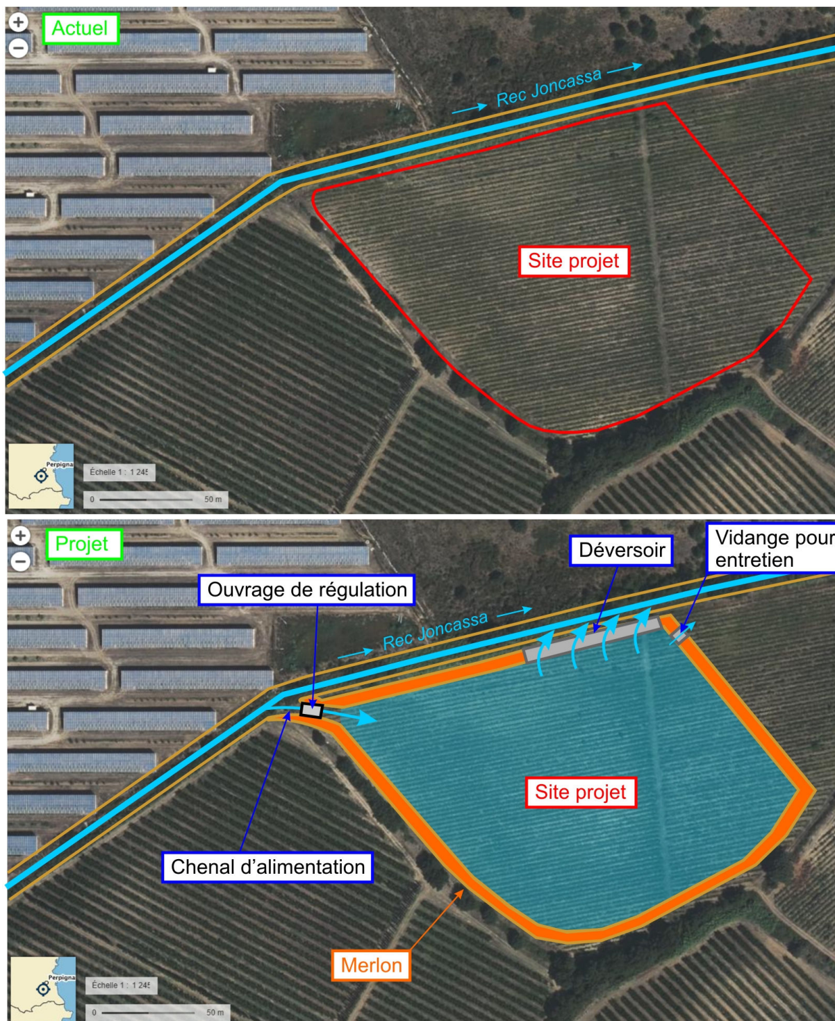
Schéma de principe du bassin de stockage - Geoportail
