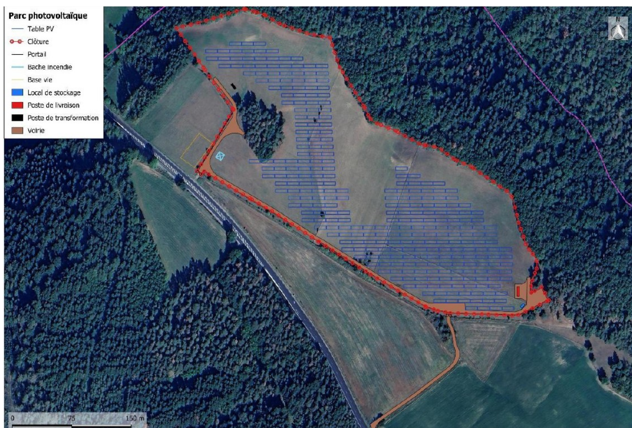
Figure 2: Implantation des installations du projet (source : dossier)
