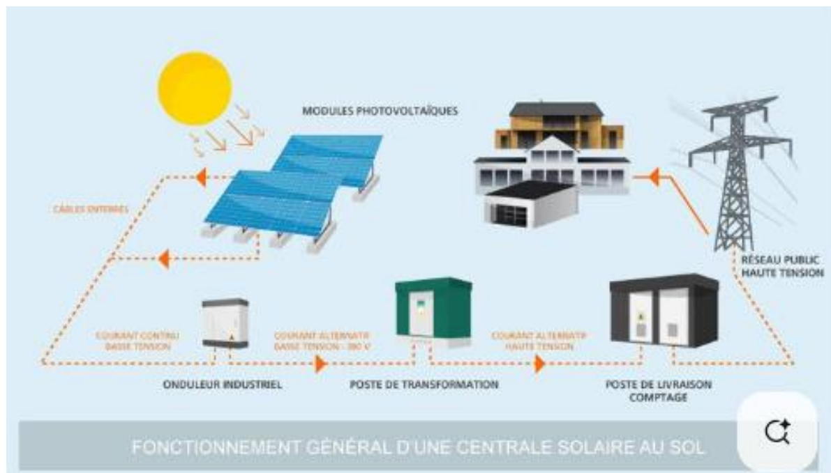
Figure 5 : Fonctionnement général d'une centrale solaire au sol
