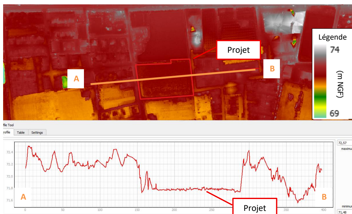
Illustration 11 : Profil ouest-est de la parcelle projet montrant un encaissement de 50 cm par rapport aux parcelles voisines
