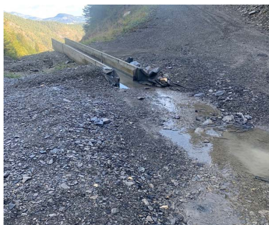
Chenal de mesure des débits, installé à la cote 1 528 m au lieu-dit « Prévache ». Le 23/09/2023 au lendemain d'un orage, le débit mesuré était de 1,15 l/s
