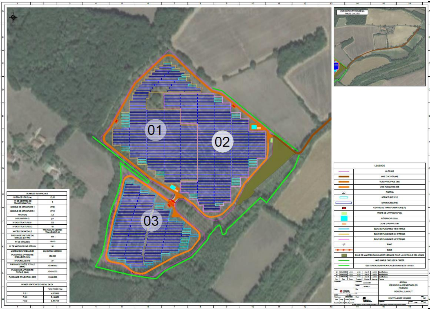
Figure 8 : Variante d'implantation n°3 (Source : Amda Energies)
