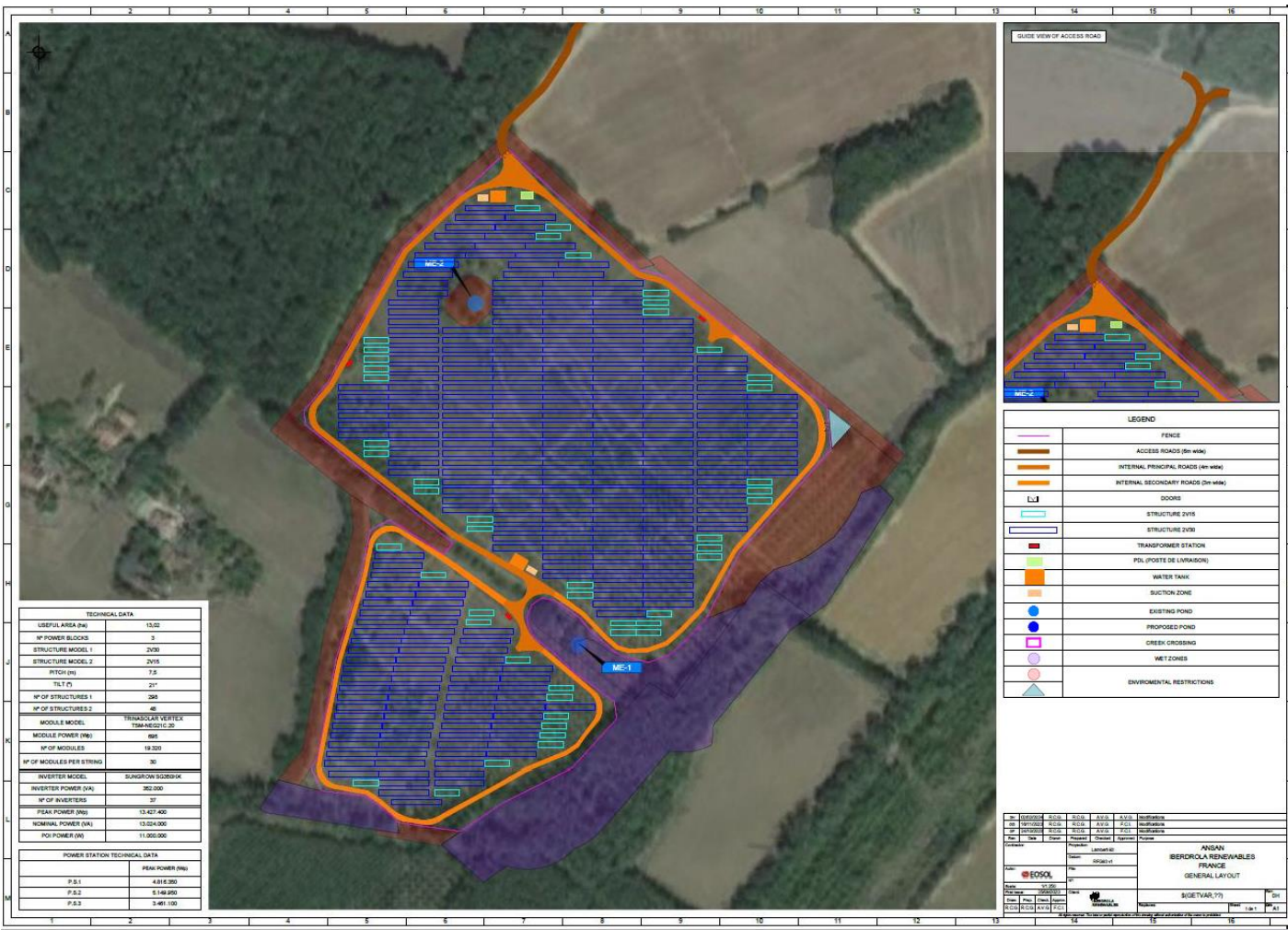
Figure 7 : Variante d'implantation n°2 (Source : Amda Energies)
