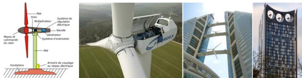
Eoliennes à axe horizontal
