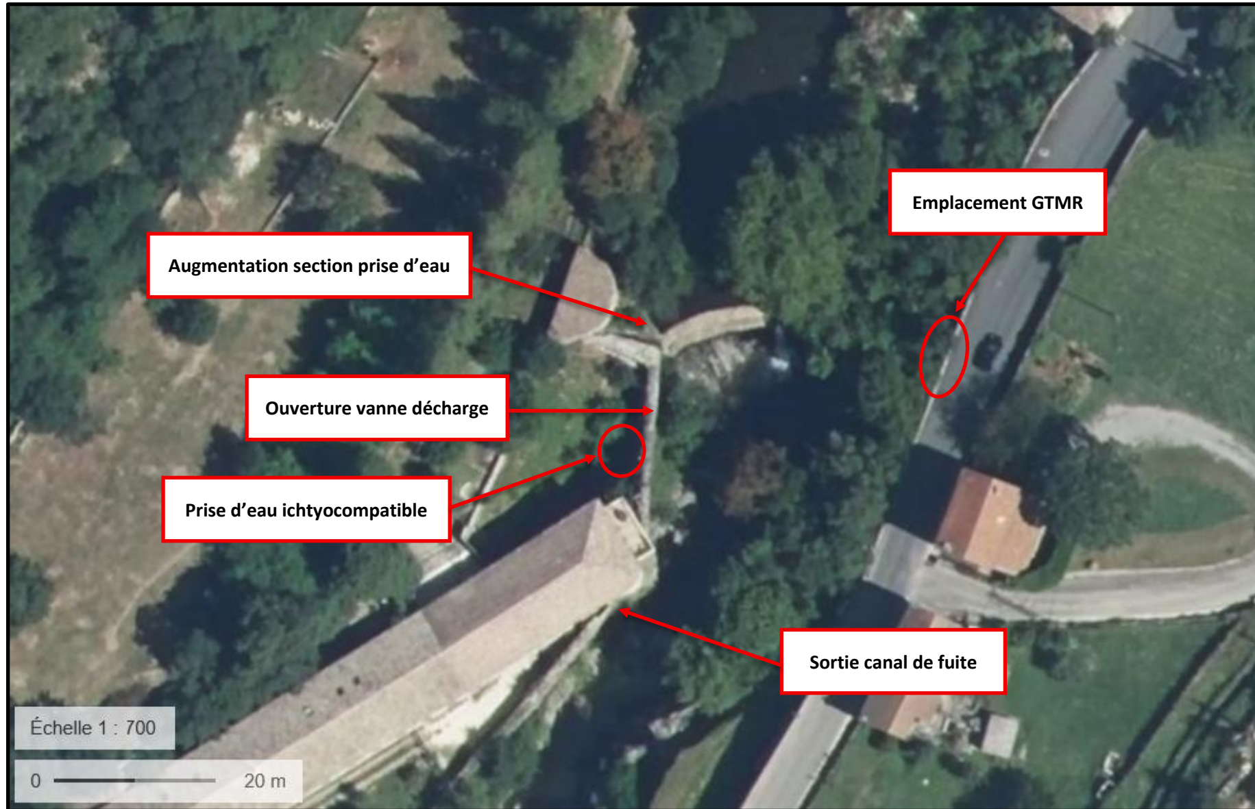
Figure 35 : Travaux réalisés sur le site de la MCHÉ Moulin de la Combelle
