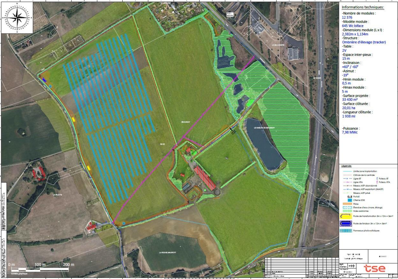
Figure 16 : Plan d’implantation du projet agrivoltaïque d’Ecommoy – plan masse du projet (Source : TSE)
