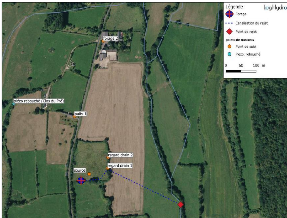
Figure 12 : Localisation des points de mesures lors des pompages d'essai précédents et points d'accès à la nappe recensés – LogHydro, 2020
