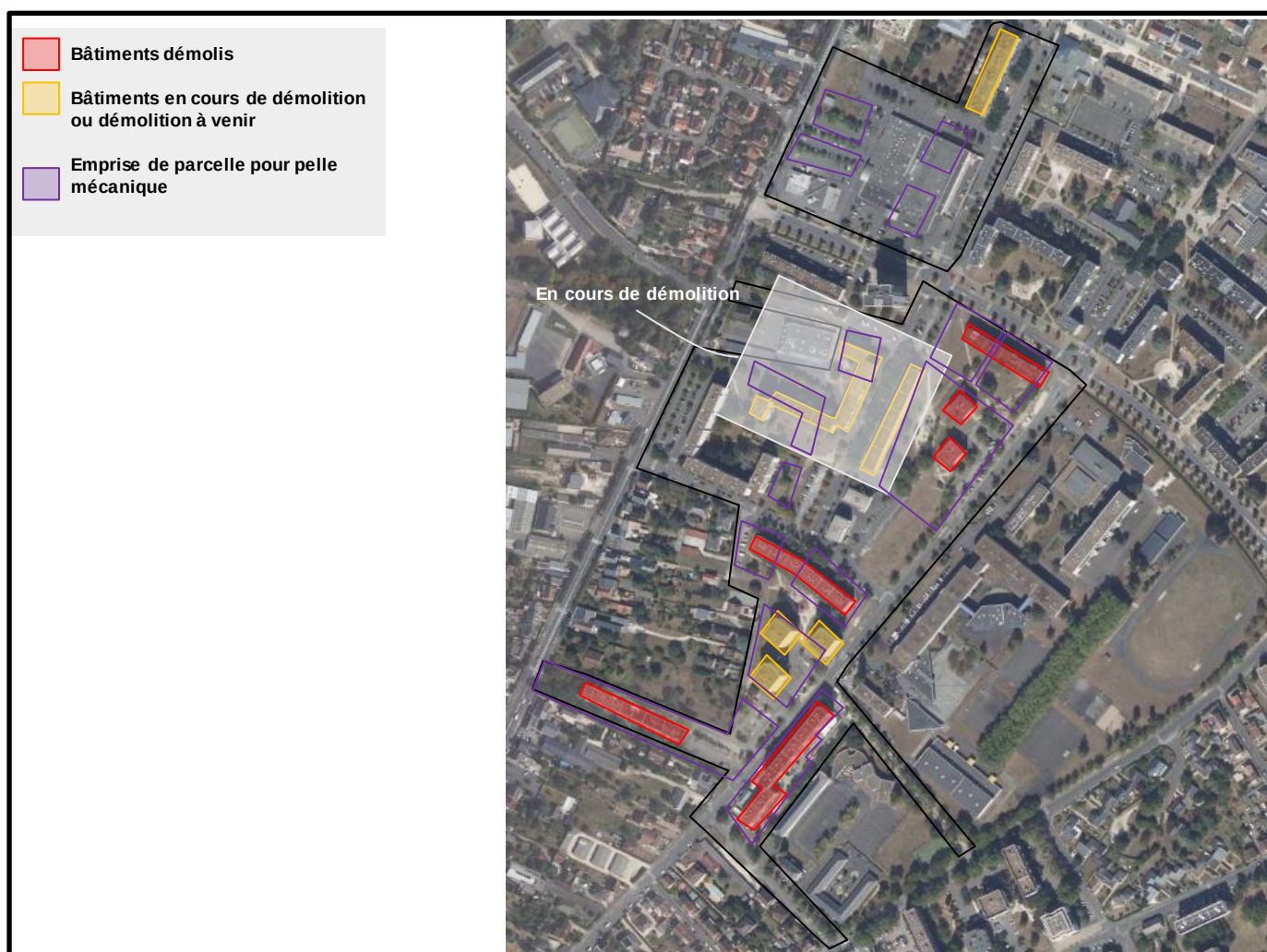
Figure 3 : Etat de démolition lors de notre intervention
