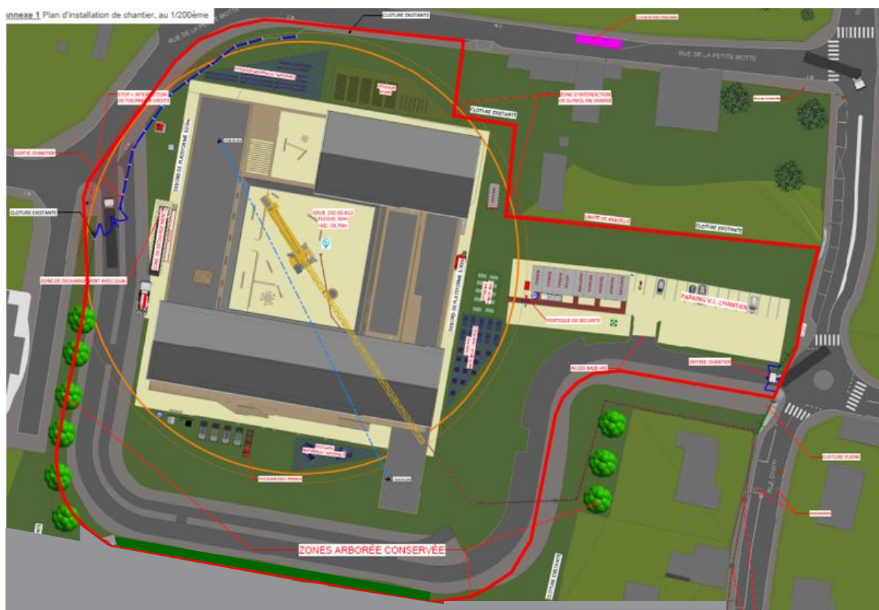
Figure 5 : Plan d'Installation de Chantier prévisionnel
