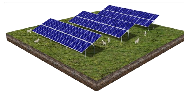
Figure 7 : Schéma de principe de l'agrivoltaïsme impliquant une production ovine (Source : ENCIS Environnement)
