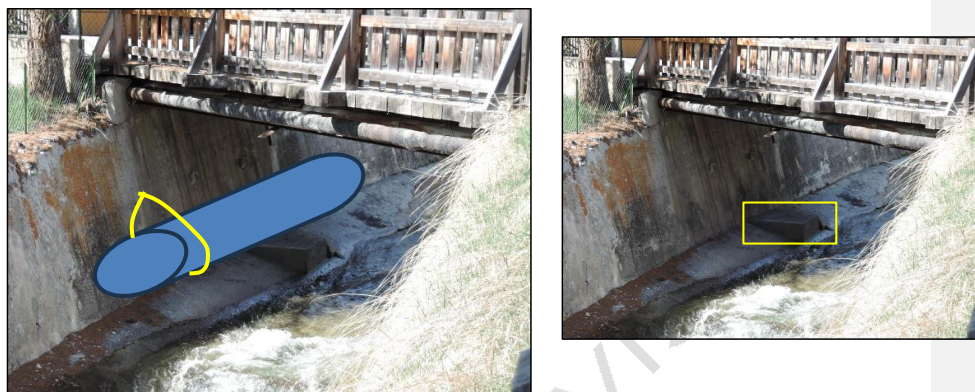
Figure 31 : Schématisation du mode de dérivation des eaux.
