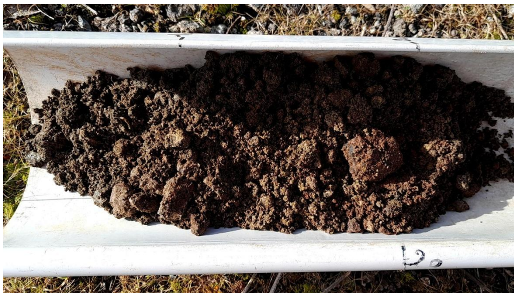
Figure 20 : Photographie d'un sondage illustrant la présence d'un remblai très graveleux (Source : ©Mélina TURPAUD, SEGED, 2026)
