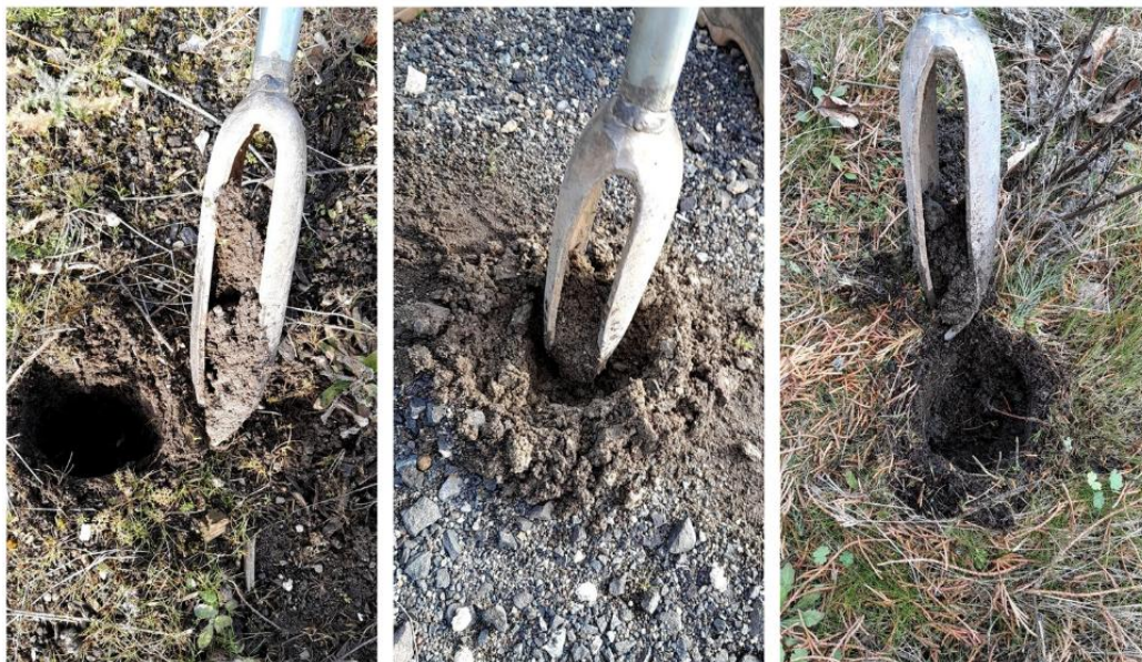
Figure 19 : Photographies des sondages effectués sur la zone d'étude, graves visibles (Source : ©Mélina TURPAUD, SEGED, 2026)
