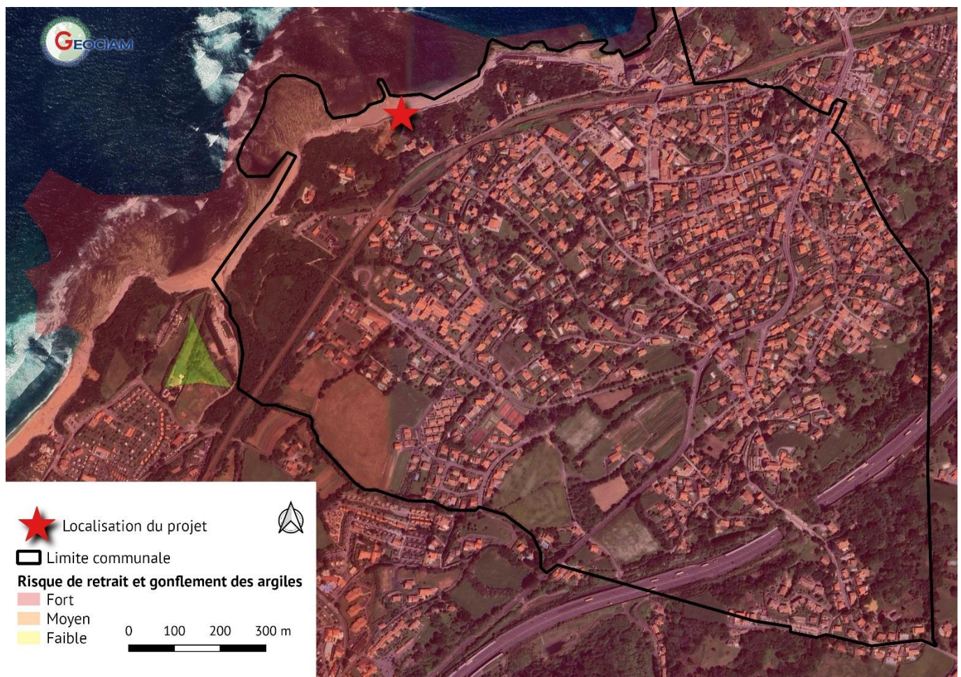
Figure 34 : Risque de retrait et gonflement des argiles sur la commune de Guéthary (Sources : Google satellite, Géorisques ; Cartographie : GEOCIAM)
