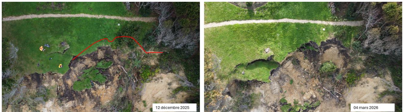
Figure 8 : Glissement du plateau sur la zone Ouest en 2026 (Source : ANTEA Group)
