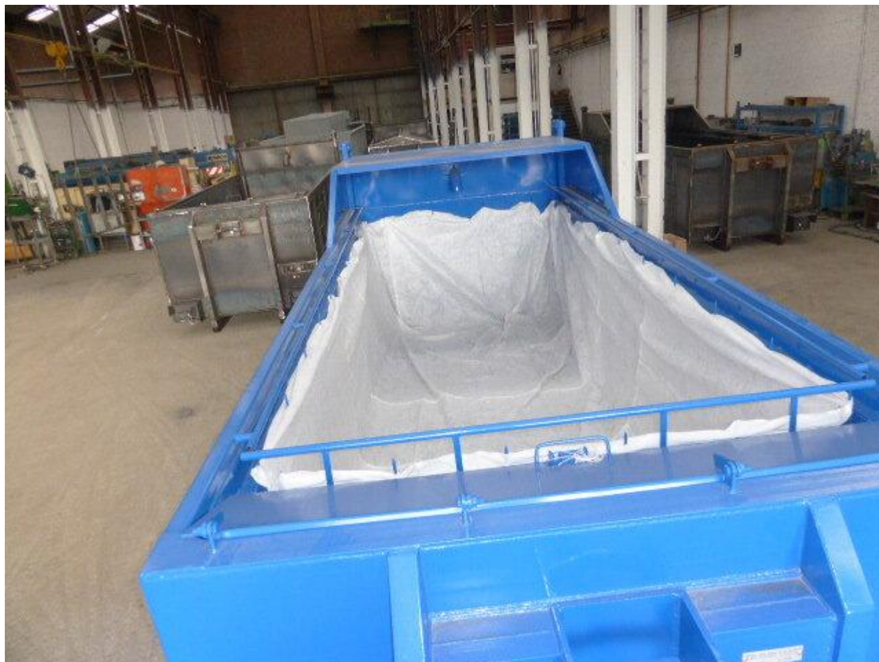
Figure 23 : Visuel représentatif d'une benne filtrante avec toile filtrante jetable
