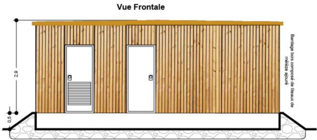
Figure 17 : Poste de livraison avec transformateur intégré bardage bois
