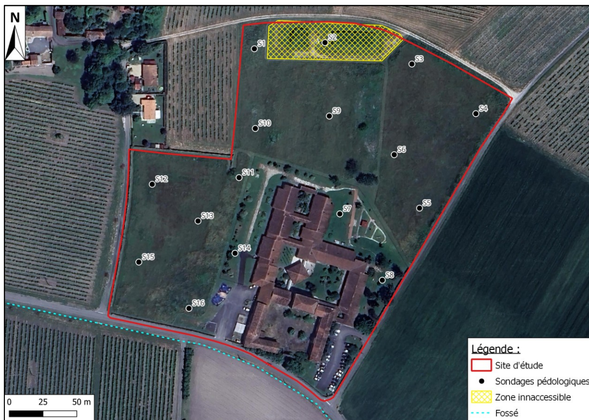
Figure 18 : : Plan d'implantation des sondages pédologiques (Source : Etude de délimitation de zones humides – CERAG, 2025)
