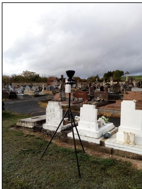
Photo 1 : Pluviomètre à auget installé au niveau du cimetière de Preuilly-sur-Claise
