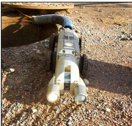
Photo 1 : Caméra utilisée pour l'inspection
