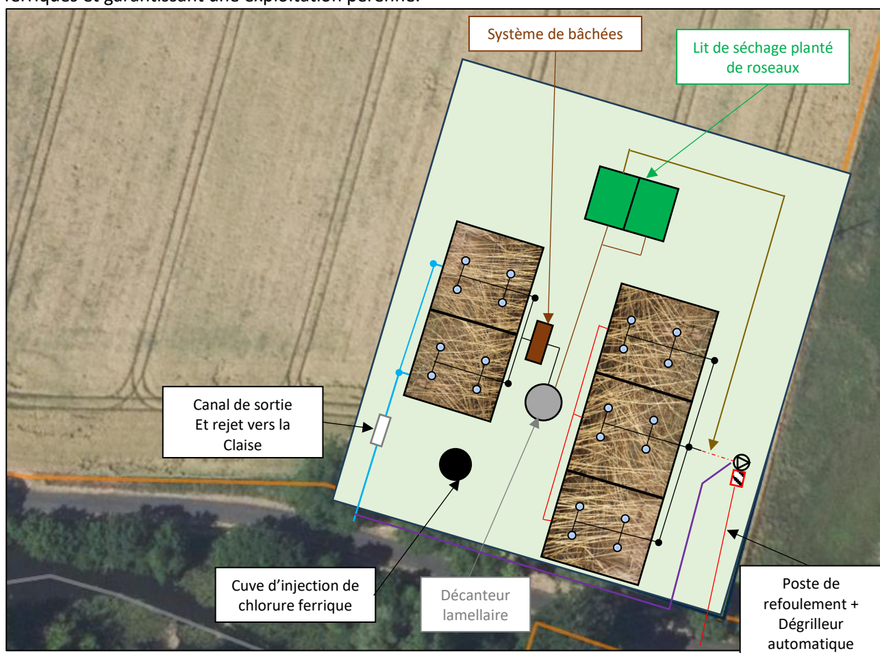
Figure 34 : Mise en place d'une station de traitement de type filtres plantés de roseaux avec injection de chlorure ferrique
