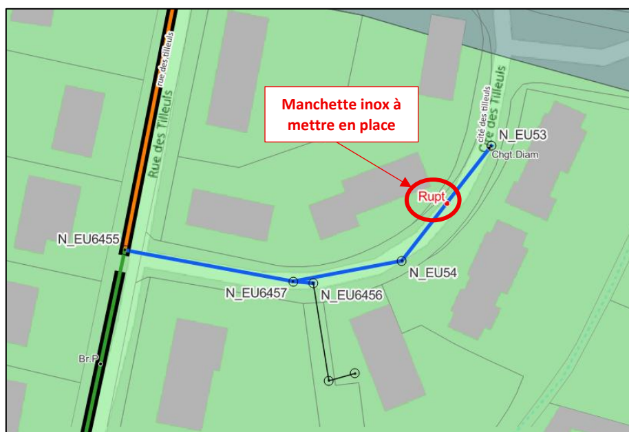
Figure 41 : Travaux à prévoir Cité des Tilleuls
