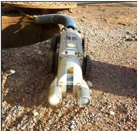
Figure 1 : Caméra utilisée pour l'inspection
