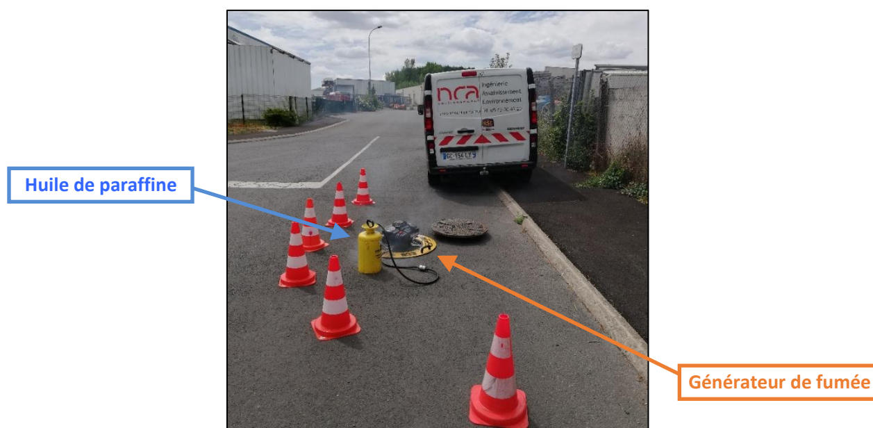
Figure 18 : Installation utilisée pour les tests fumigènes
