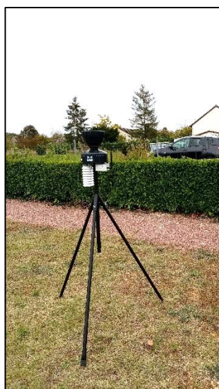
Photo 1 : Pluviomètres à auget installés au niveau de la STEU Le Ruton à Descartes (gauche) et à Abilly (milieu)
