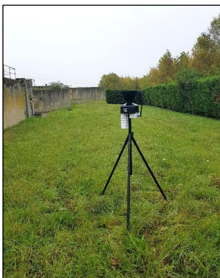
Photo 1 : Pluviomètres à auget installés au niveau de la STEU Le Ruton à Descartes (gauche) et à Abilly (milieu)
