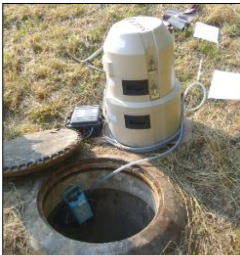
Photo 29 : Préleveur autonome pour la réalisation de bilan de pollution sur 24 heures
