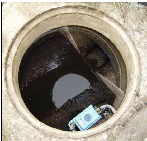
Photo 24 : Exemple de mise en place d'une sonde de niveau et de son enregistreur couplés à un seuil triangulaire
