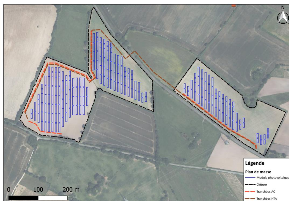
Figure 33 : Tranchées du projet de Verrières (Source :ZE Energy et NCA Environnement)
