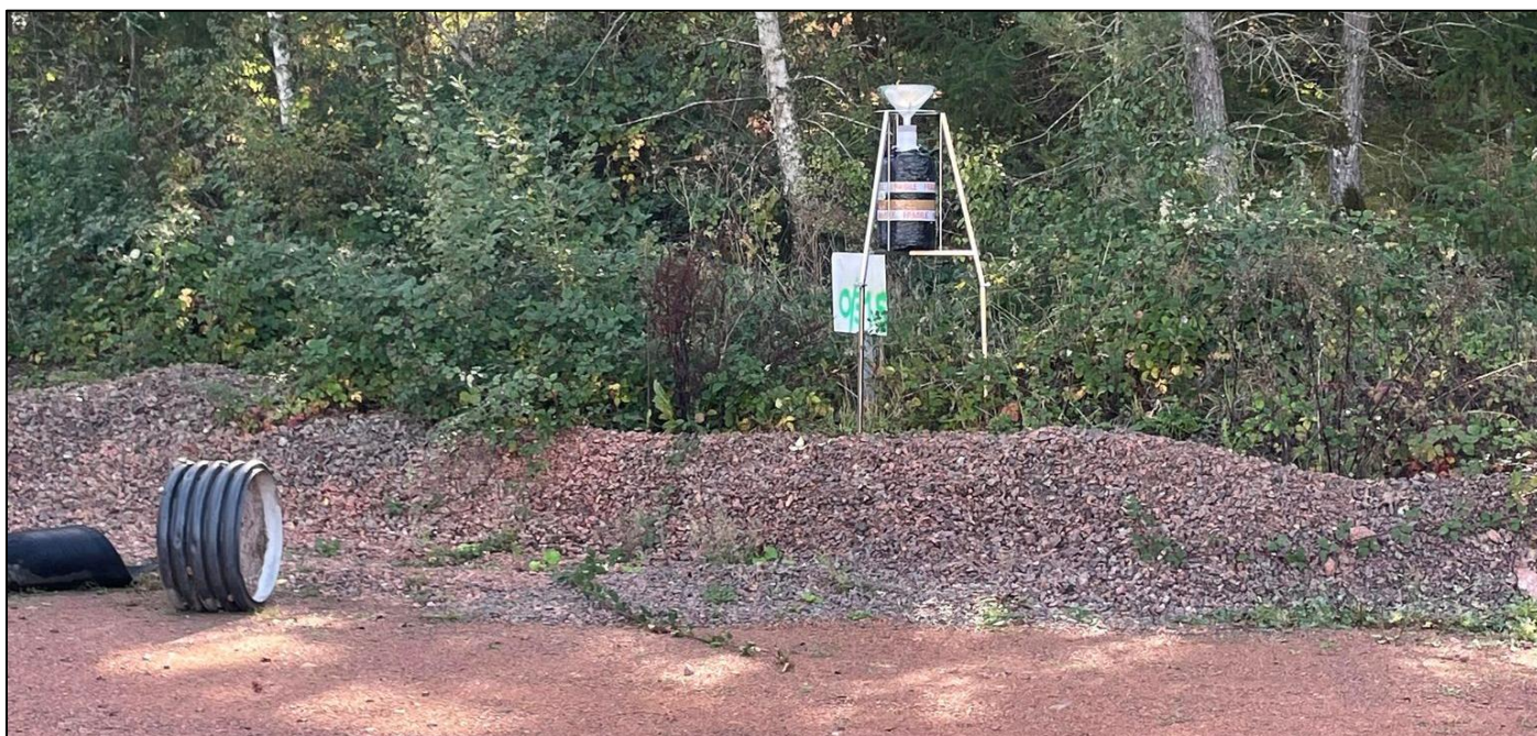
Figure 1 - Illustration d'un préleveur de type « jauge Owen » en place
