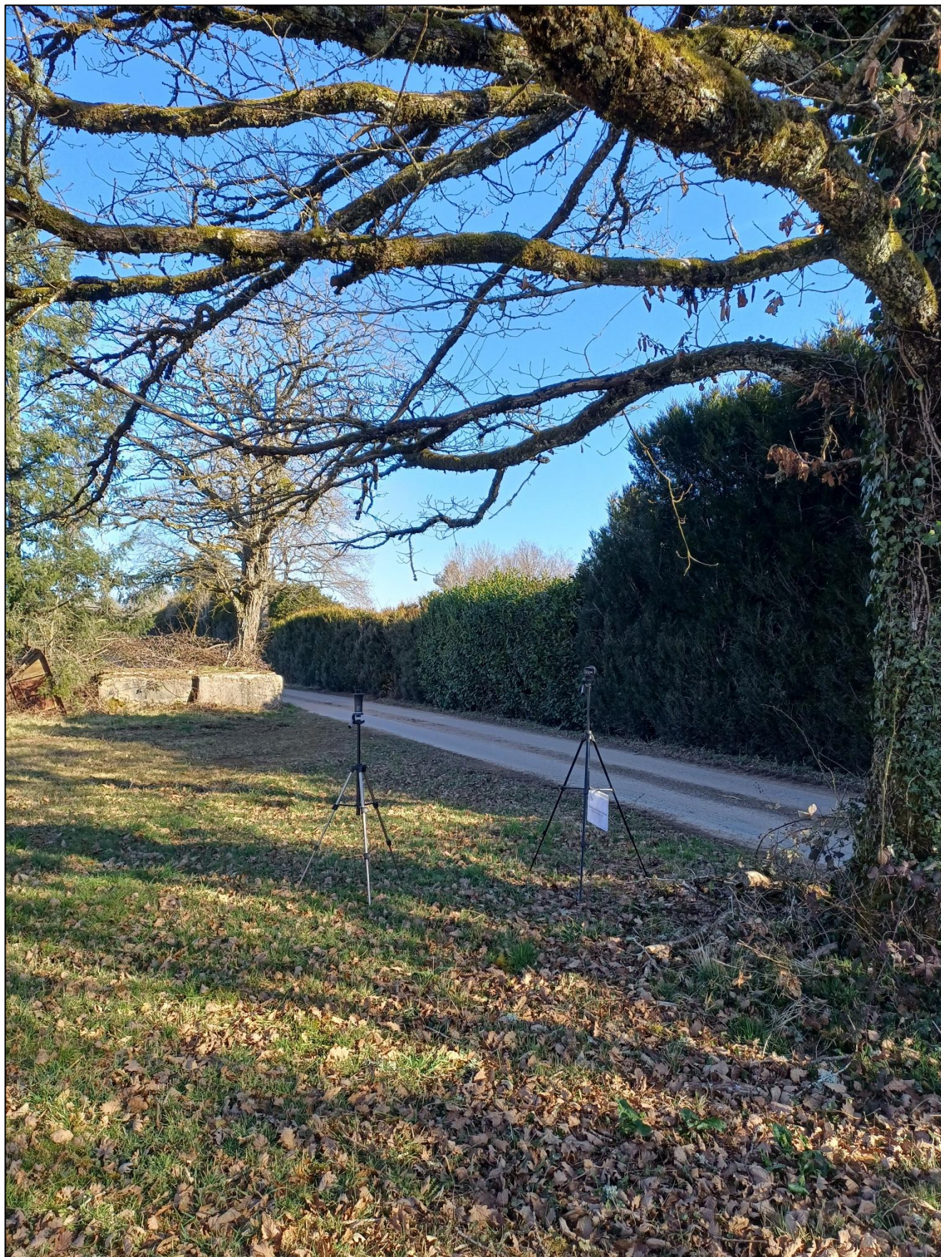
Figure 11 : Photographie du sonomètre lors des mesures des niveaux sonores en limite de Zone à Emergence Réglementée (Point ZER-1 sur Figure 1)
