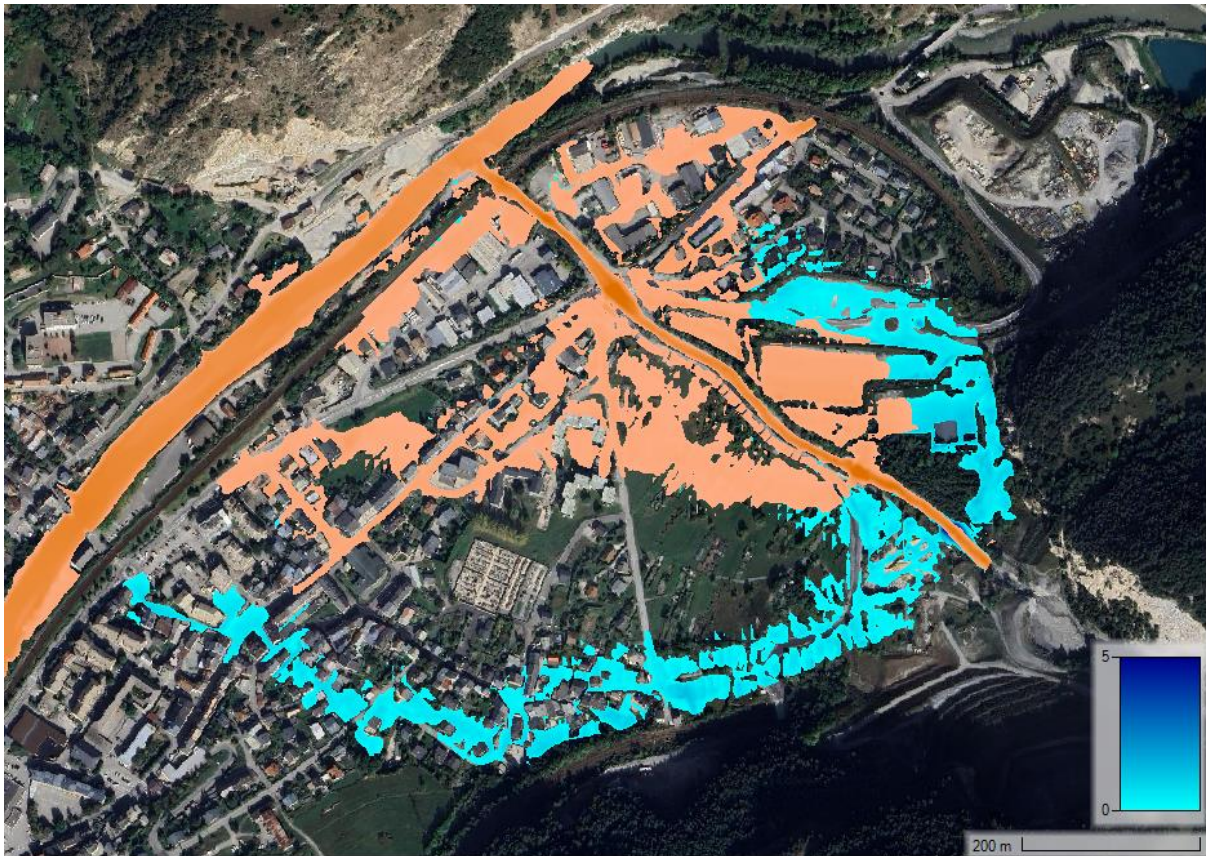
Figure 90 : vue en plan des débordements modélisés avec un hydrogramme de crue extrême pour une rhéologie « Extrêmement Fluide TTTF », avec obstruction quasi-totale en amont du cône de déjection, en position 1 (orange) et 2 (bleu).
