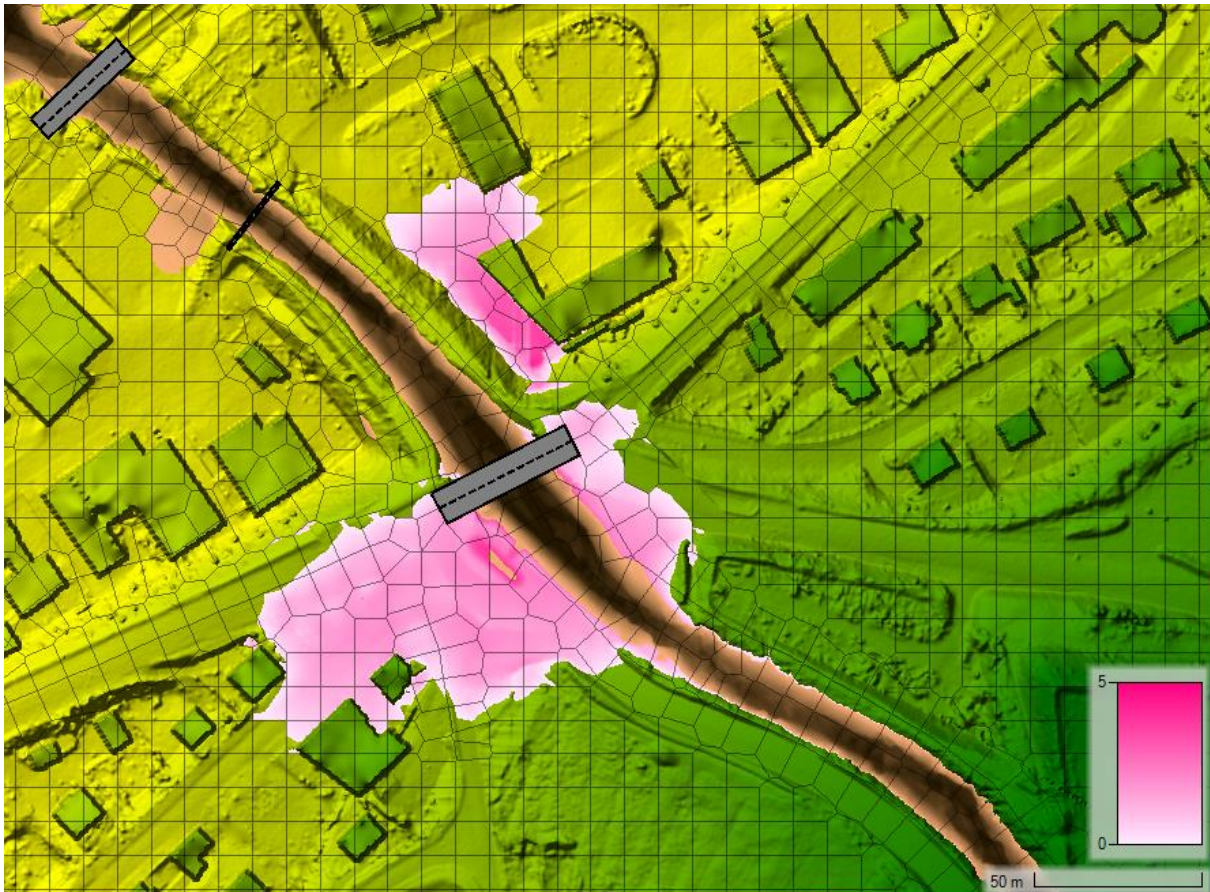
Figure 64 : vue en plan des débordements modélisés avec un hydrogramme Q100 pour une rhéologie « Très visqueuse », sans obstruction du pont (marron) et avec obstruction quasi totale du pont (rose)
