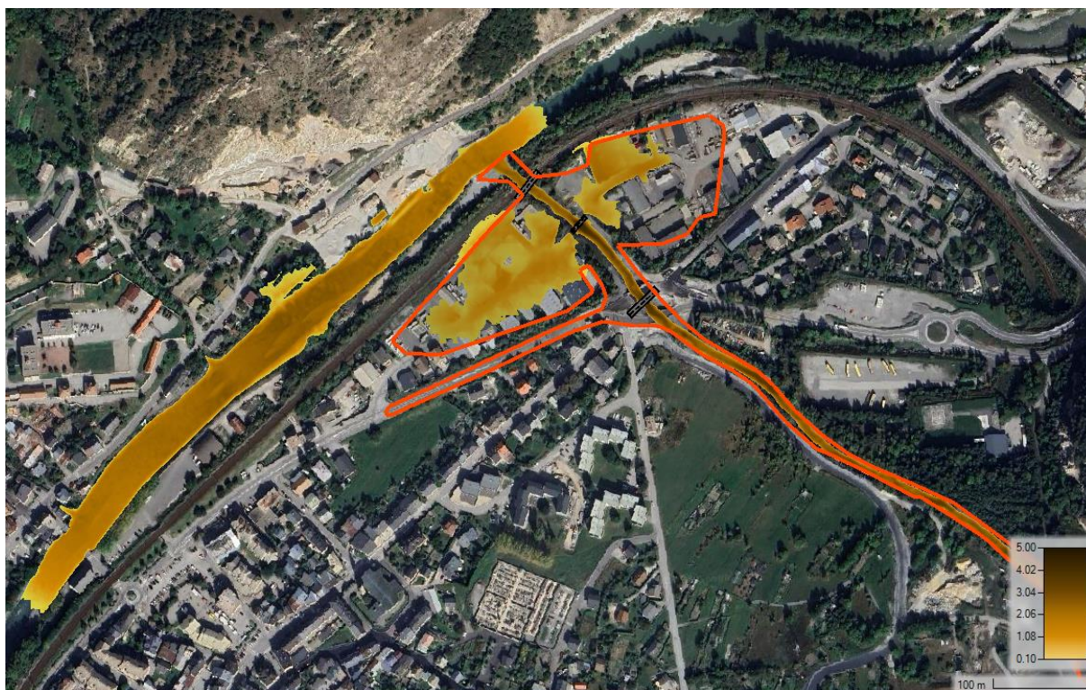
Figure 43 : Emprise de la crue de 2014 resimulée avec la rhéologie de 500 Pa « Extrêmement fluide TTF »
