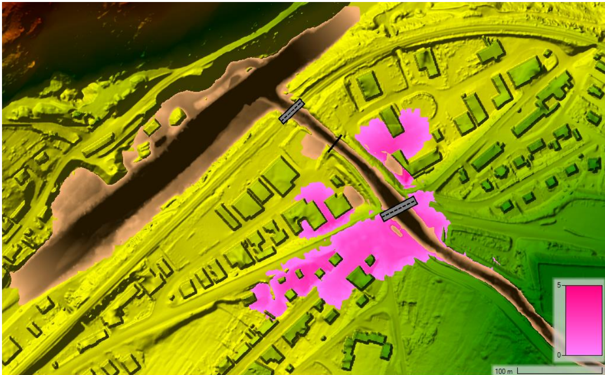
Figure 80 : vue en plan des débordements modélisés avec un hydrogramme de crue exceptionnelle pour une rhéologie « Très visqueuse », sans obstruction du pont (marron) et avec obstruction quasi totale du pont (rose)
