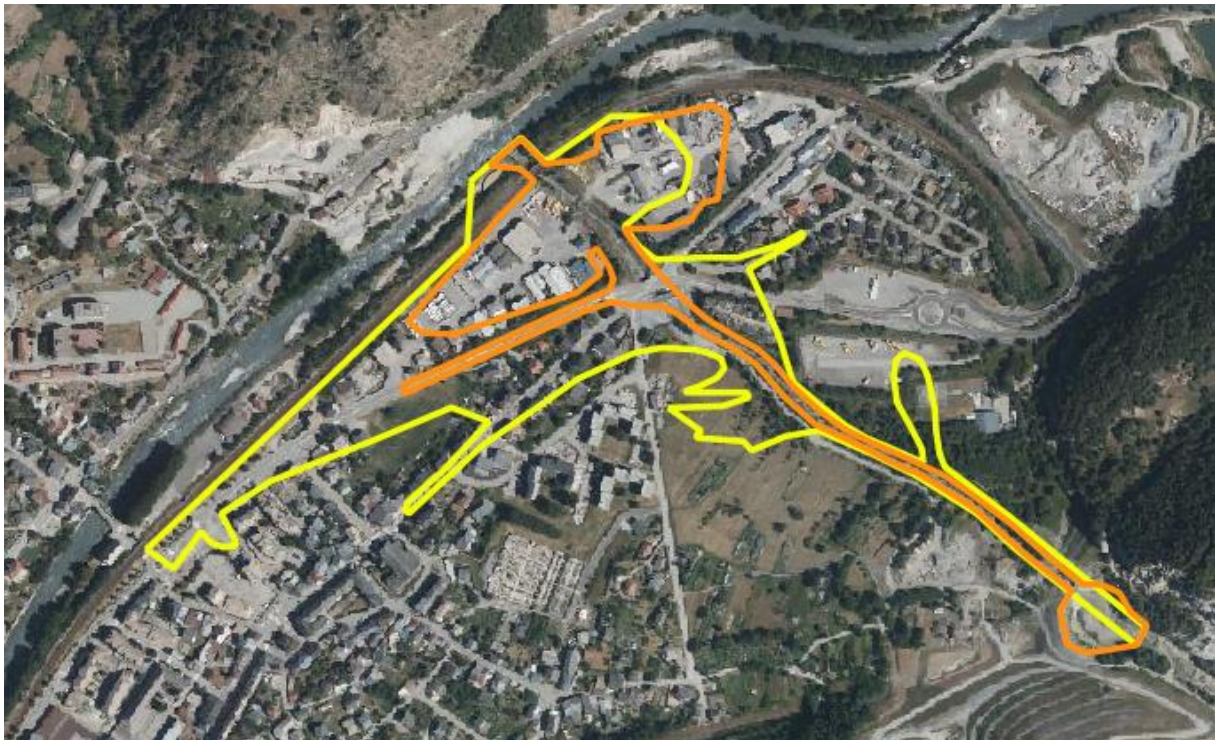
Figure 32 : Emprise des débordements des crues de 1987 (jaune) et 2014 (orange) reproduite d'après RTM 2016 et Lombardi 2018 (EDD)
