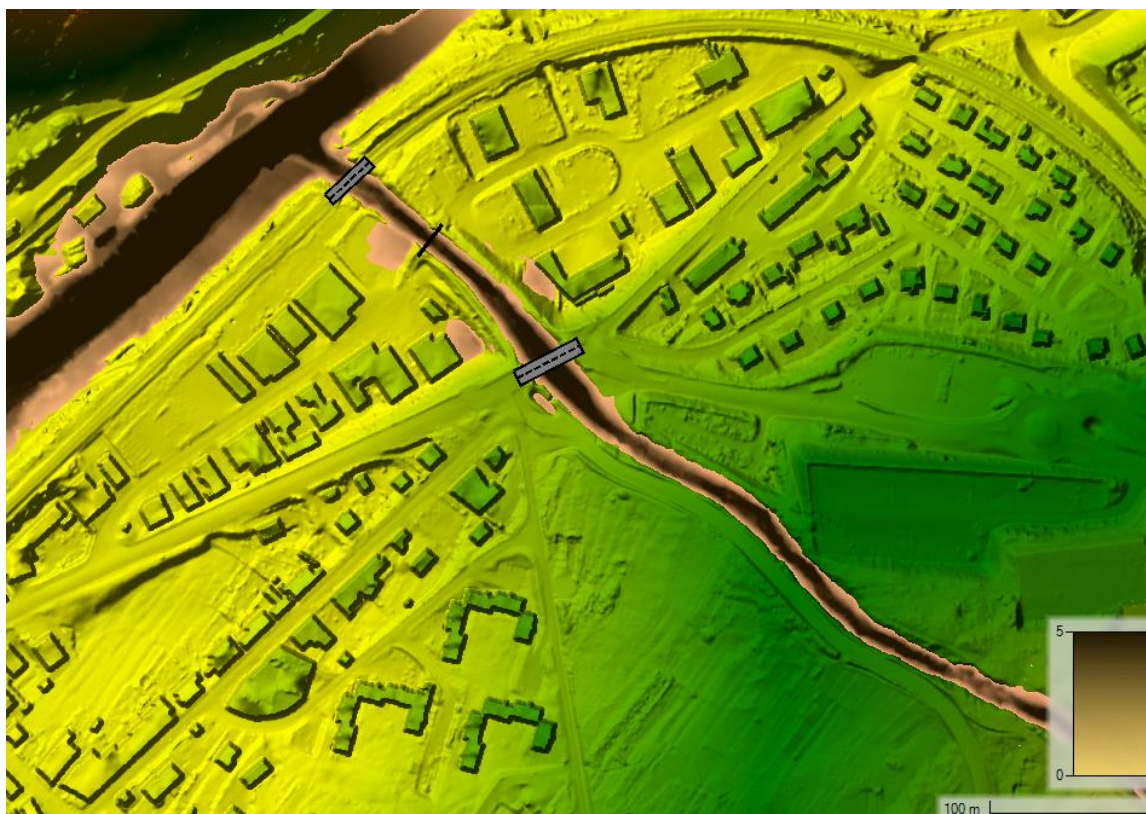
Figure 77 : vue en plan des hauteurs et des débordements modélisés avec un hydrogramme Q100 pour une rhéologie « Très Visqueuse »,
