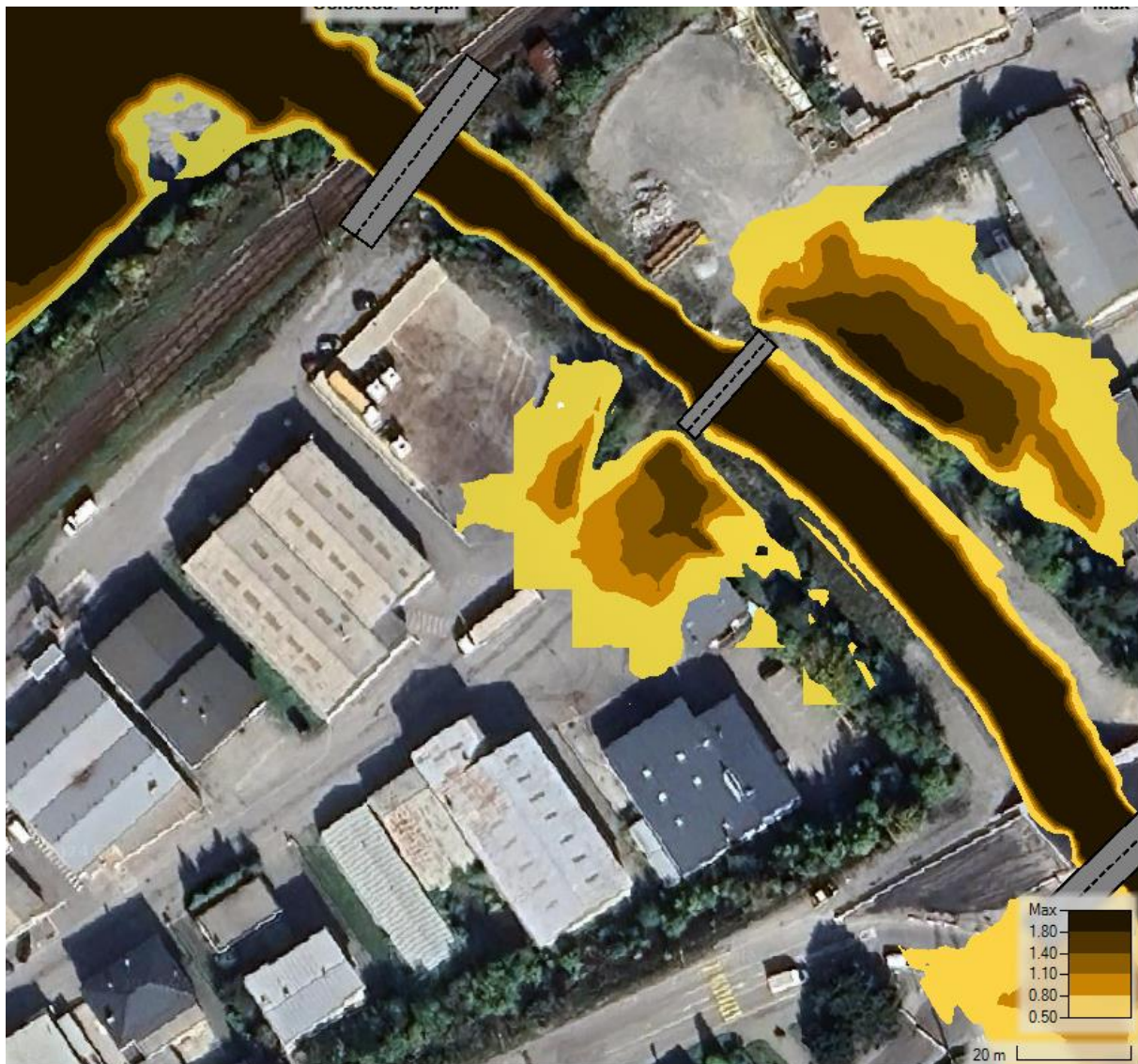
Figure 38 : hauteur de lave modélisée pour l'hydrogramme de la crue de 2014 et la rhéologie « très visqueuse »
