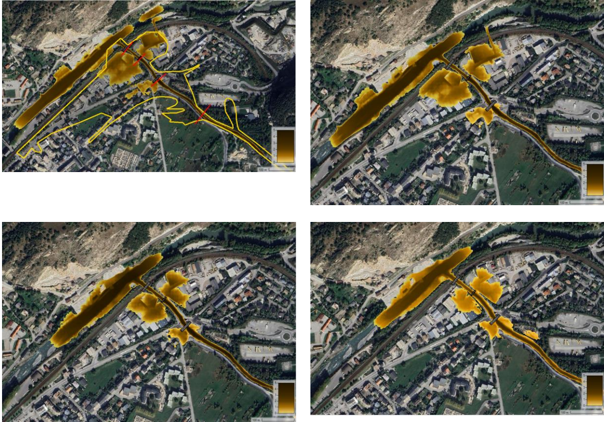
Figure 40 : Emprise des écoulements pour 4 jeux de paramètres rhéologiques testés. De gauche à droite et de bas en haut : très fluide, fluide, visqueux et très visqueux. Pour le cas très fluide, les positions des 4 profils en travers exploités ci-dessous ainsi que l'emprise de la crue de 1987 sont indiqués.
