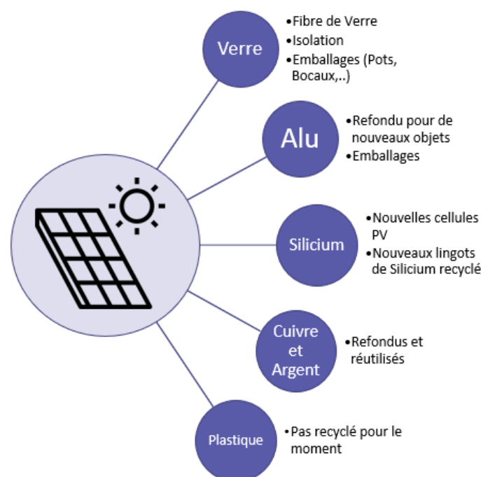
Figure 32: Composants d'un module PV
