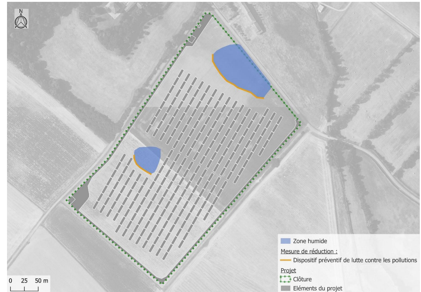
Double barrières de rétention installées à la périphérie de l'emprise du chantier et conjuguées à des boudins en fibres de paille maintenus au sol par des sacs de graviers.
