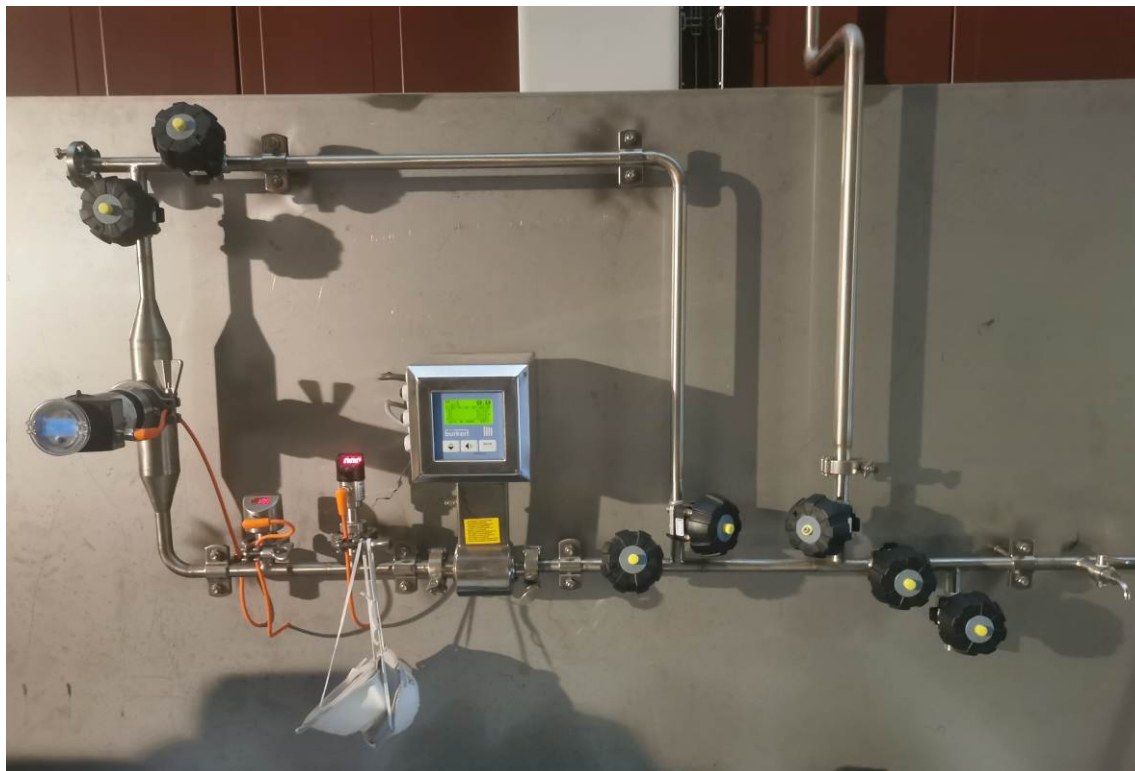
Figure 6 : Photographies du forage F3 et du tableau d'appareillage pour l'enregistrement de paramètres en continu pendant le pompage d'essai
