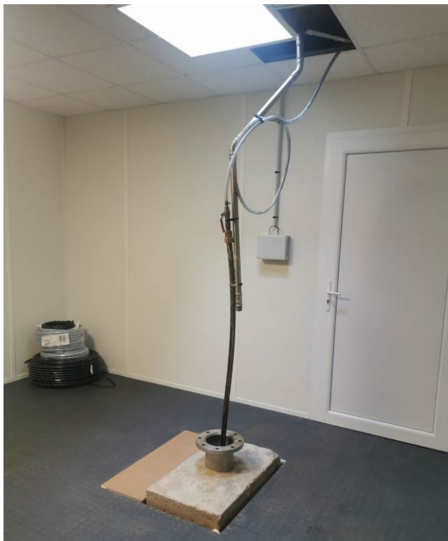
Figure 6 : Photographies du forage F3, du tableau d'appareillage pour l'enregistrement de paramètres en continu pendant le pompage d'essai, et l'environnement extérieur du site du Pestrin
