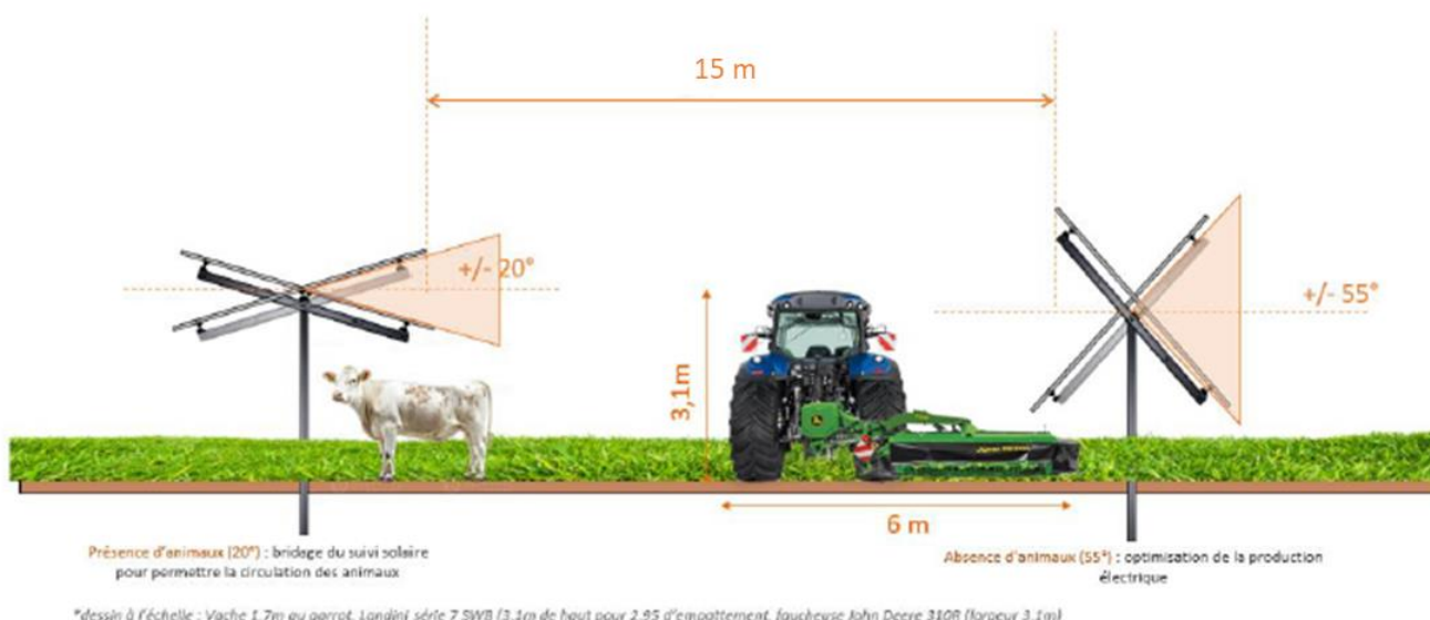
Illustration 1 : Exemple d'une structure photovoltaïque au sol
