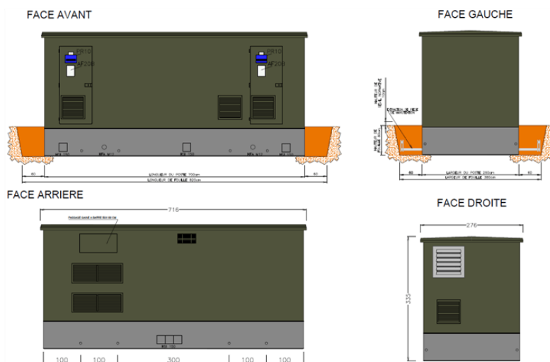
Illustration 3 : Poste de livraison
