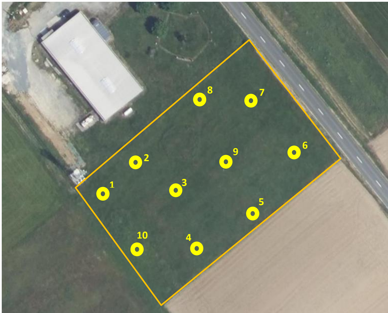
Localisation des sondages pédologiques effectués
