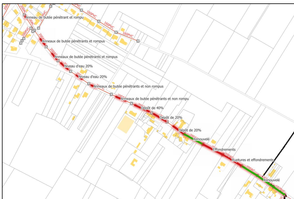
Figure 16 : Extrait des ITV – Défauts recensés sur le tronçon 484-TRU-0535
