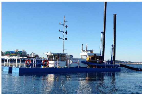
Drague aspiratrice type Dredge 670-12.8M
