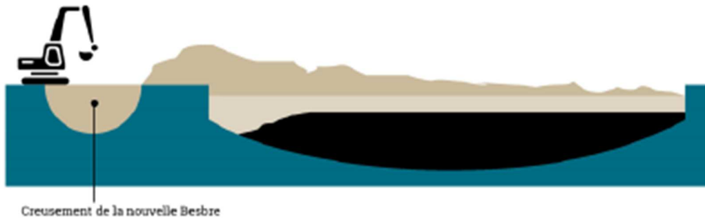
Figure 5 : schéma de principe du creusement de la nouvelle Besbre et de la mise en œuvre du dôme émergé (source Orano Mining)
