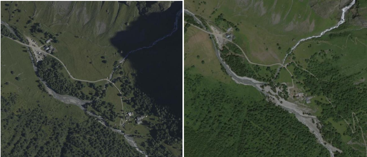
Comparaison des orthophotos de 2012 (à gauche avant la crue) et de 2016 (à droite après la crue). Les merlons de curages post crue sont bien visibles sur l'orthophoto de 2016
