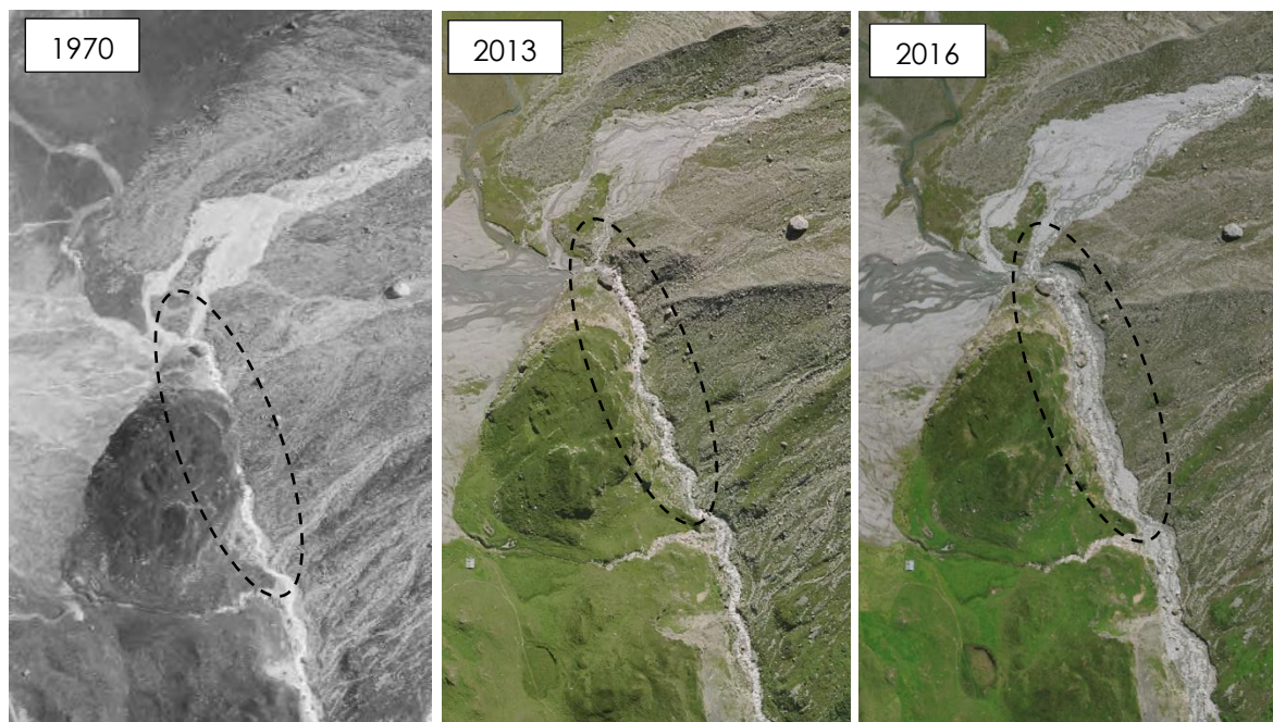
Figure 24 : évolution de la largeur du lit en aval du verrou rocheux suite à la crue de 2015
