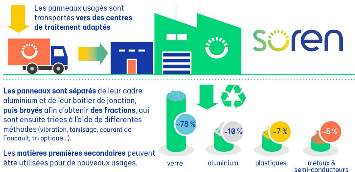
Figure 22 - Le traitement des panneaux photovoltaïques par SOREN.
