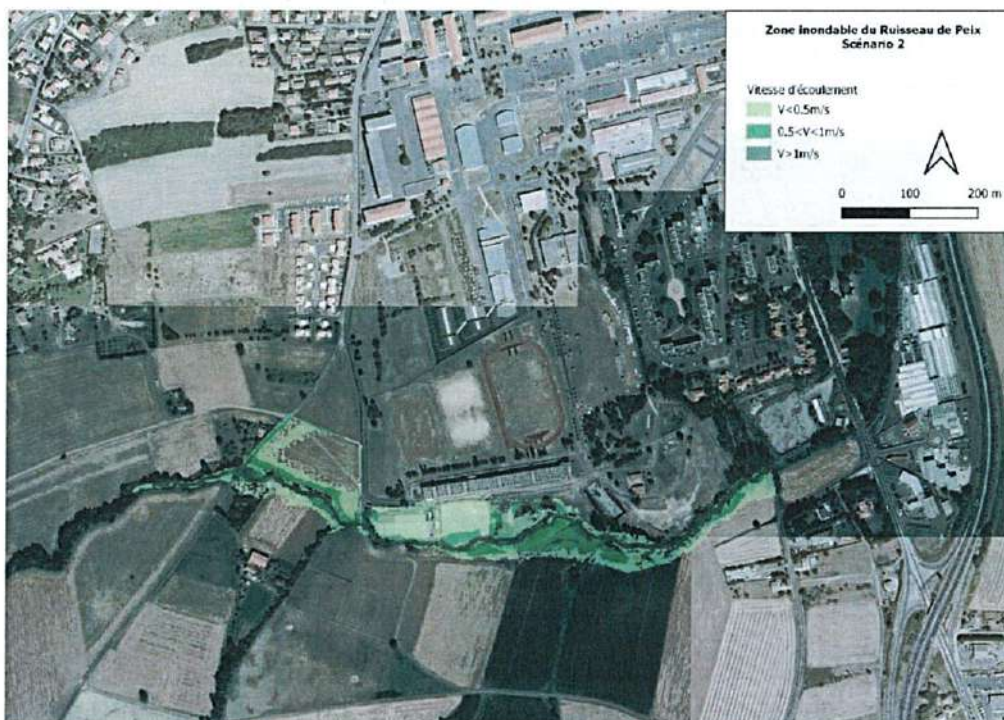
Figure 27 : carte des vitesses d'écoulement à l'état aménagé pour le scénario 2
