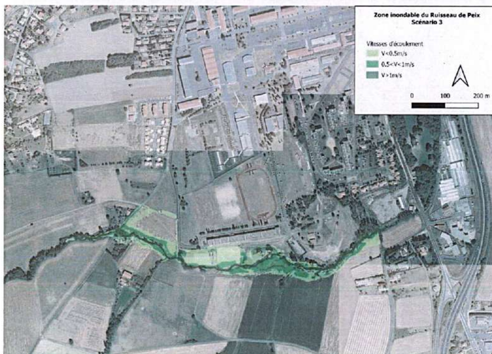
Figure 38 : carte des vitesses d'écoulement pour le scénario 3
