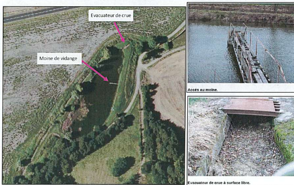
Figure 12 : Fonctionnement de l'étang de la Fontaine
