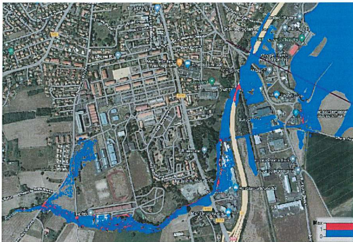
Figure 25 : Cartographie du nombre de Froude en sortie du modèle pour la crue centennale
