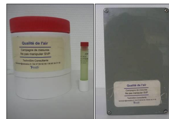
Figure 3 : Réceptacle, tube passif pour le \text{NO}_2 et micro-capteur laser pour les particules
