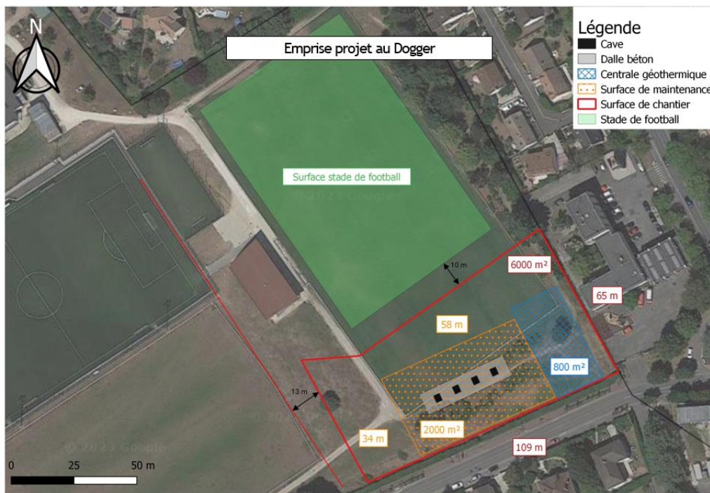
Figure 5 - Surface mobilisées pour le projet de géothermie
