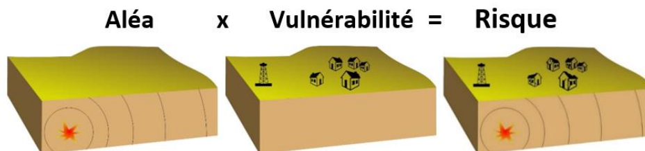
Figure 7 : Définition du risque sismique (source : INERIS & BRGM)
