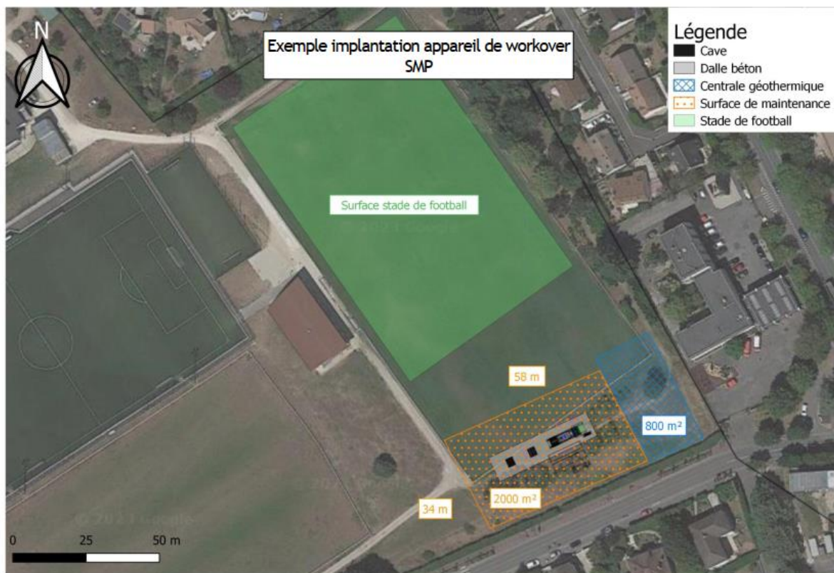
Figure 12 - Implantation appareil de work-over au Dogger
