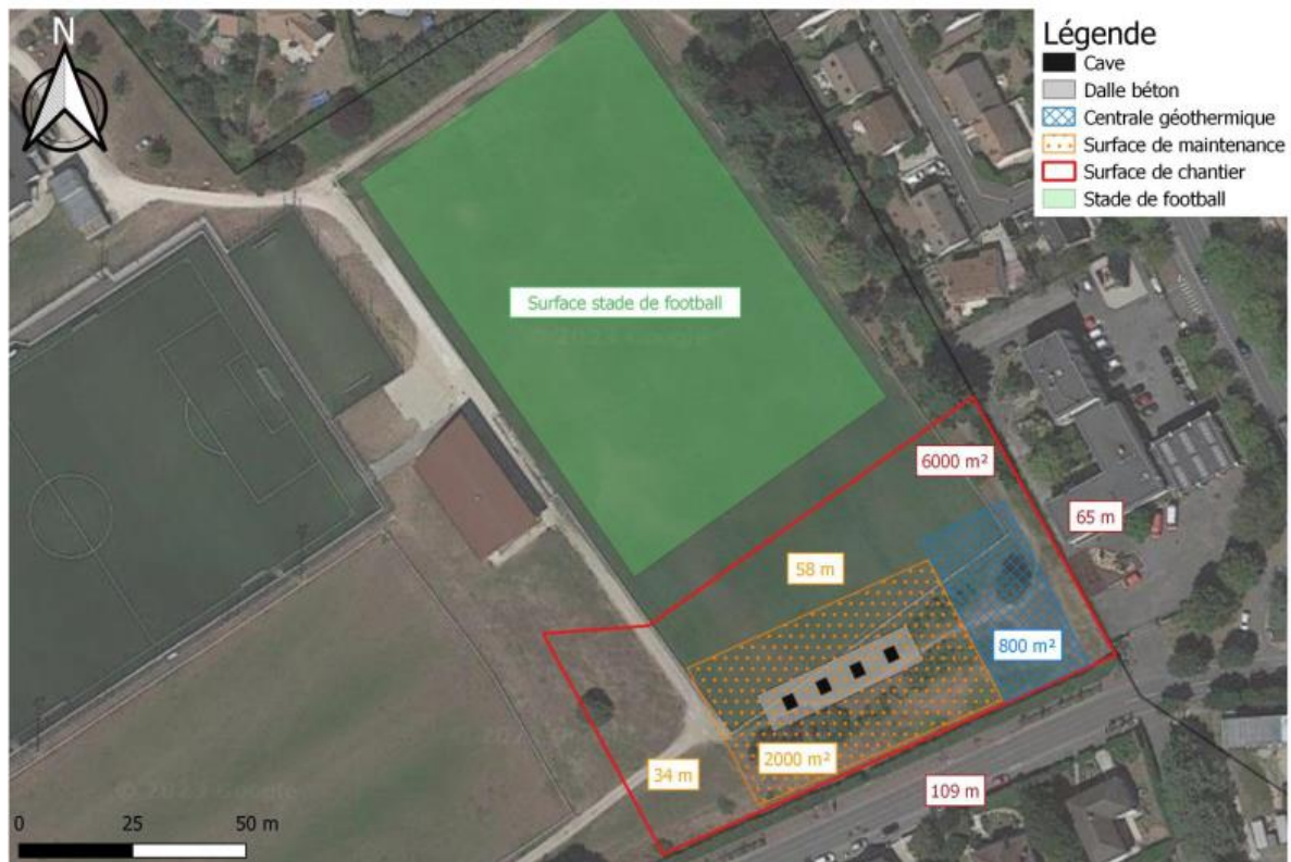
Figure 11 - Implantation plateforme de forage au Dogger
