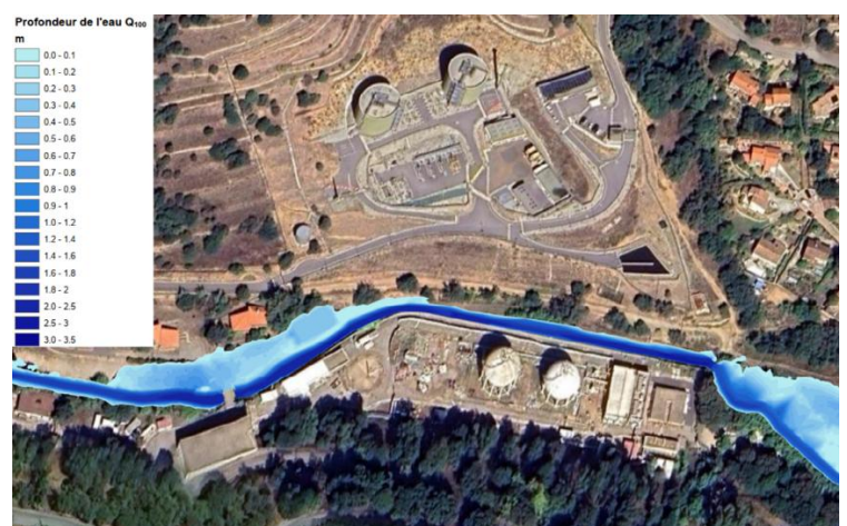
Simulation crue Q100 avec ouvrages de prévention
