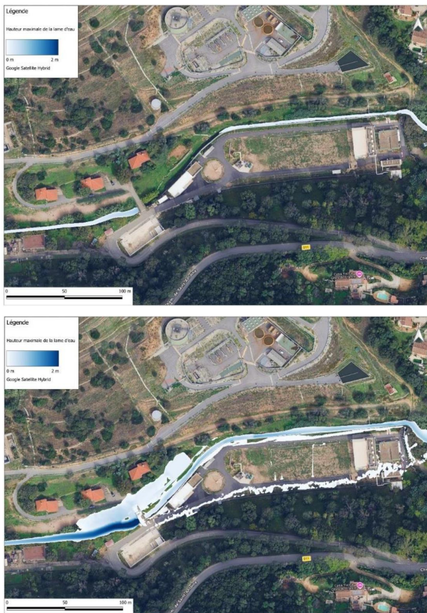
Figure 7 : Modélisation de l'Arbitrone avec canalisation de déviation Ø500mm, débit biennal « estival » (en haut) et « toute l'année » (en bas)
