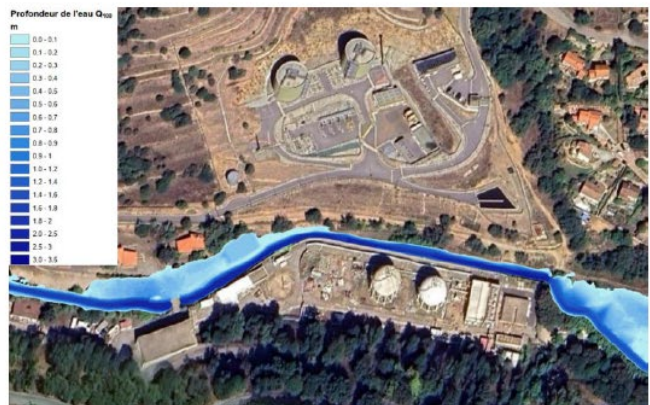
Simulation crue Q100 avec ouvrages de prévention
