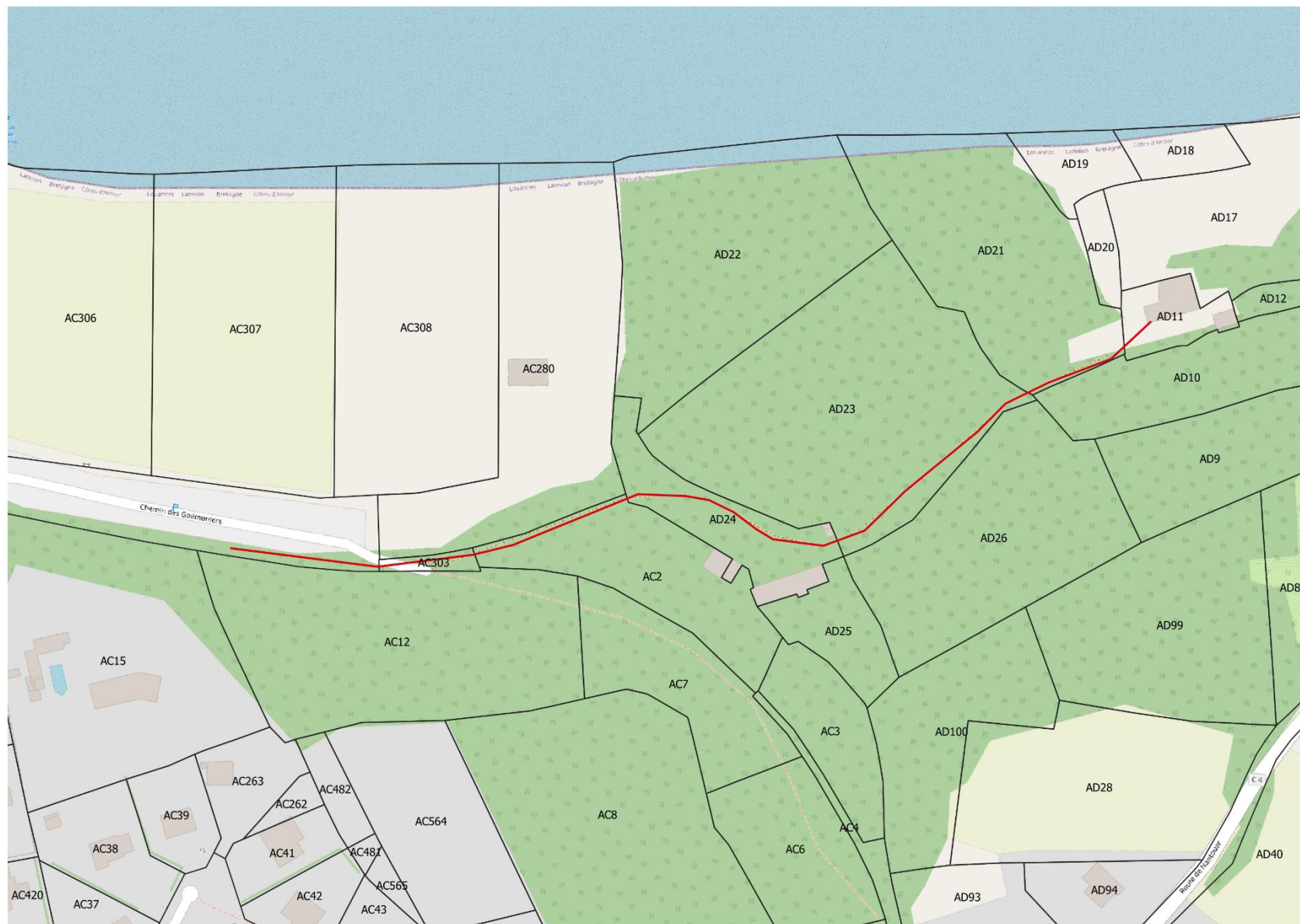
Figure 4 Projet de tracé de nouvelle conduite
