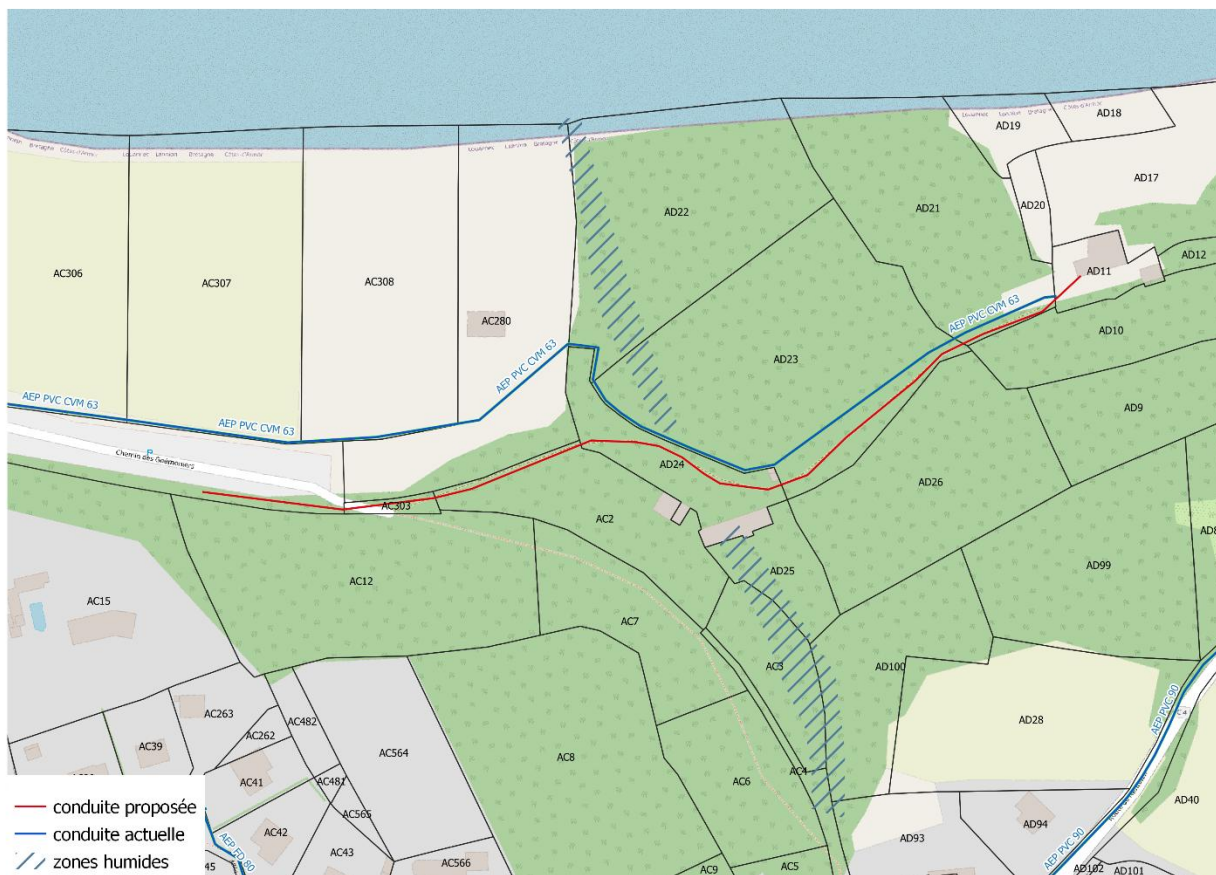
Figure 23: Tracé de la nouvelle conduite
